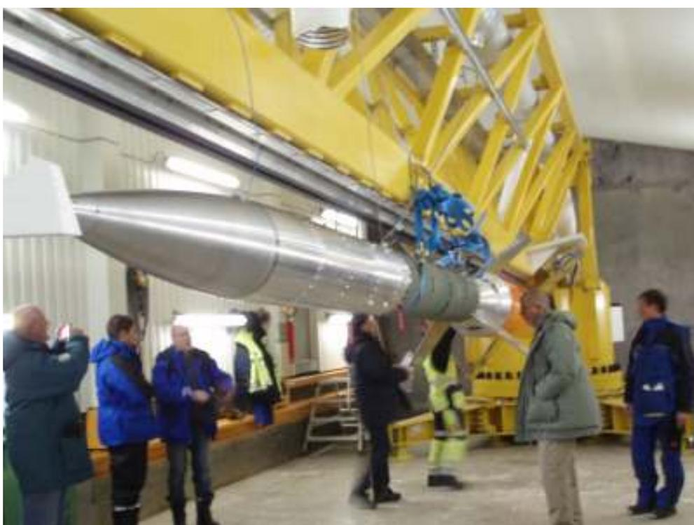
ロケットへの搭載作業が行われました。一般見学に紛れて、私たちも写真を撮りに行きました。ロケットは2段式で、 $\Phi 356 \text{ mm} \times 2915 \text{ mm}$ ,  $142.9 \text{ kg}$  のペイロードを  $348 \text{ km}$  まで運びます。
